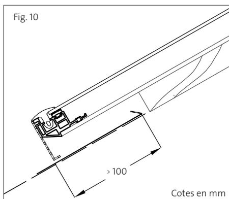
Raccordement côté gouttière
